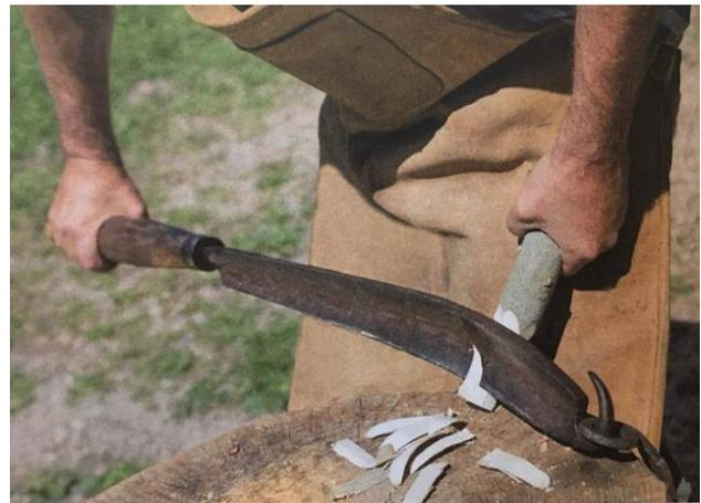
*El cuchillo de zueco es una hoja larga con un gancho que permite fijarlo al banco de trabajo. Es una poderosa herramienta para desbastar la madera, los toques finales se hacen preferentemente con una hoz plana.*
